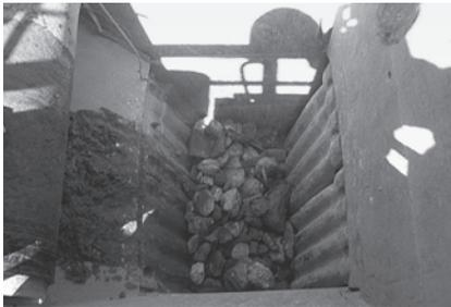
FIG. 8B. UN CONCASSEUR À MÂCHOIRES VERTICALES TEL QUE RENCONTRÉ DANS UN CENTRE DE TRI EN 2011 (CAPTURE D'ÉCRAN VIDEO). SOURCE : ROTOR ASBL.
