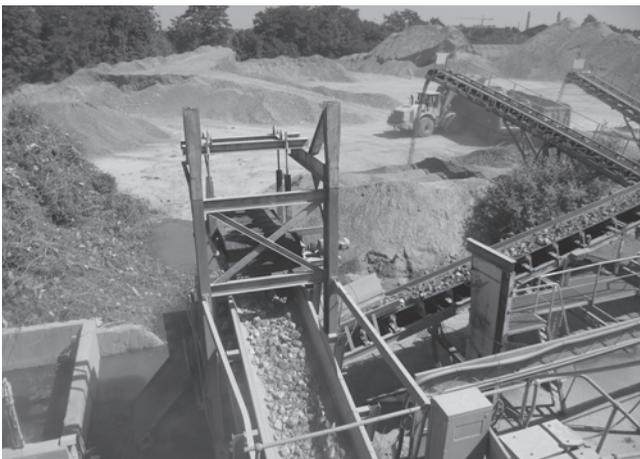
FIG. 4. UNE BANDE MAGNÉTIQUE PERMET D'ÔTER DU FLUX DE DÉCHETS TOUTS LES COMPOSANTS MÉTALLIQUES. SOURCE : ROTOR ASBL.
