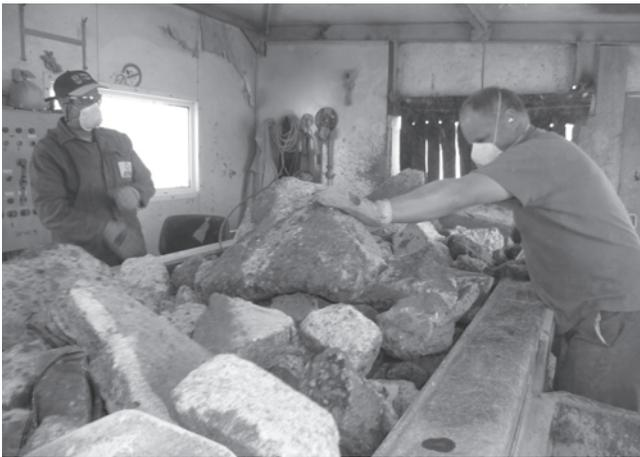
FIG. 3. DES TRAVAILLEURS PLACÉS LE LONG D'UNE BANDE ROULANTE TRIENT MANUELLEMENT LES FRACTIONS NON INERTES. SOURCE : ROTOR ASBL.
