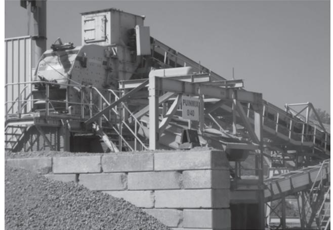
FIG. 7. APRÈS LE CONCASSEUR, LES GRANULATS SONT TRIÉS SUR DES CRIBLES QUI PERMETTENT DE LES RÉPARTIR EN FONCTION DE LEUR GRANULOMÉTRIE. SOURCE : ROTOR ASBL.
